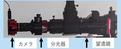
図2 低分散分光器とカメラZWO ASI 178MM(14bit モノクロ)
